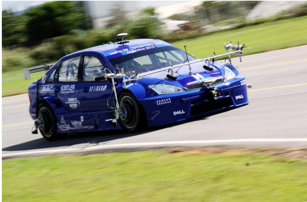
**Figura 47 – Exemplo de Veículo Completamente Instrumentado**
