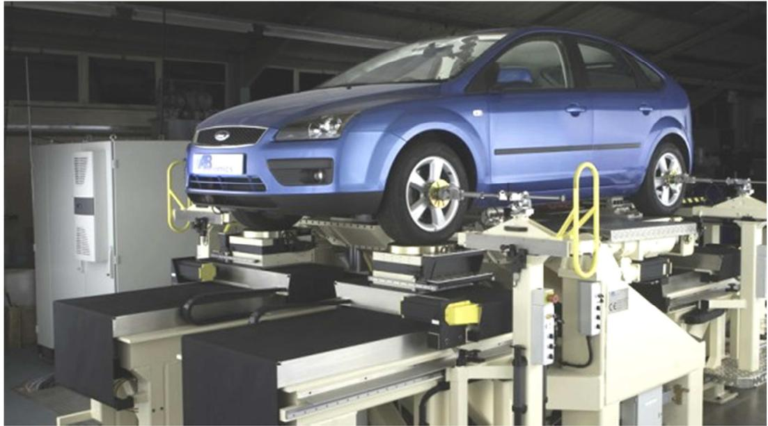
**Figura 45 - K&C – Teste de Cinemática e Complacência**
