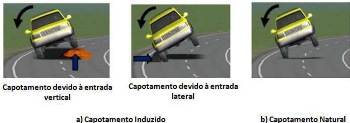
**Figura 26 - Tipos de Capotamento**
