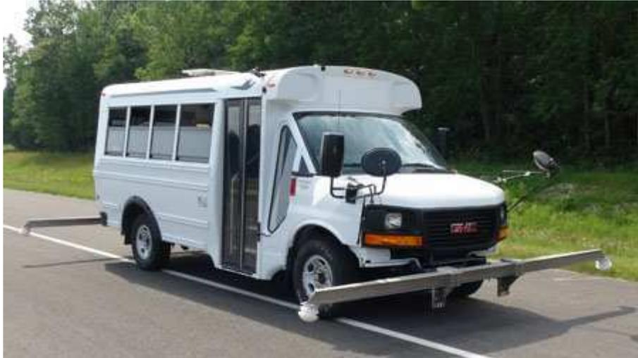
**Figura 53 - Veículo com Outrigger**
