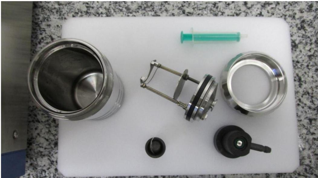
Figura 12 - Vaso de pressão do calorímetro.
