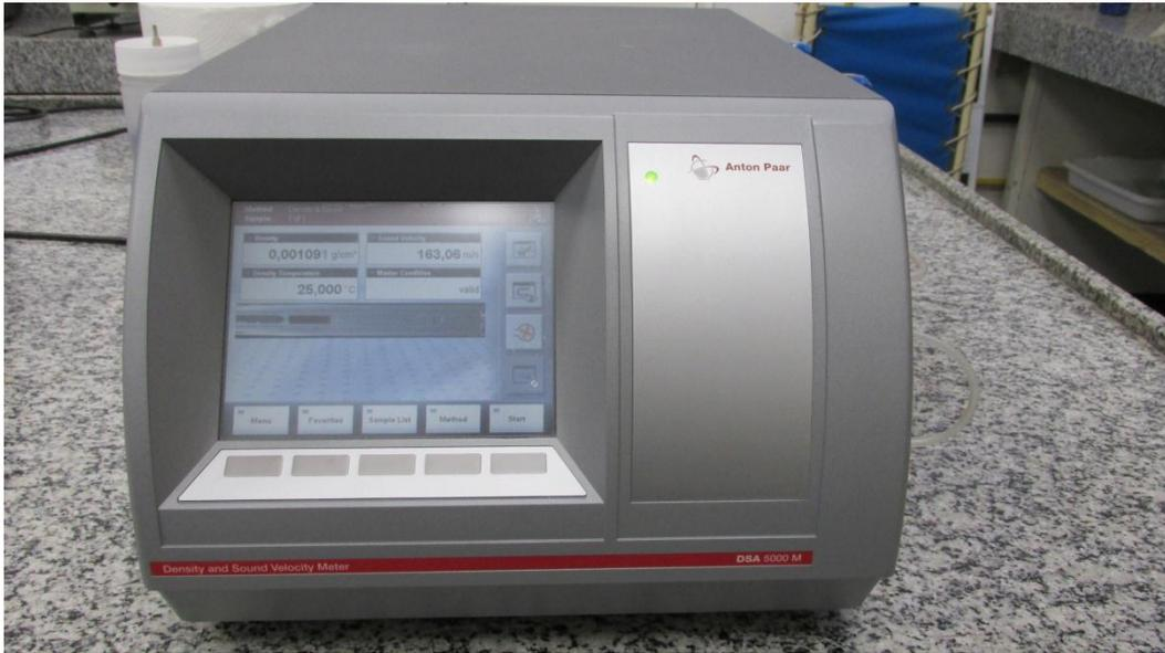
Figura 9 – Analisador de densidade e velocidade do som da Anton Paar (modelo DSA 5000).
