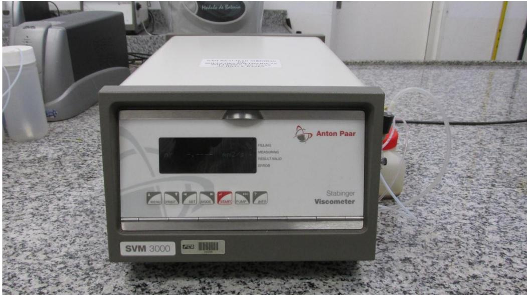
Figura 10 – Viscosímetro Stabinger da Anton Paar (modelo SVM 3000).
