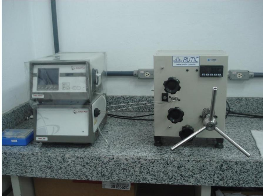
Figura 2- Equipamento DMA 4500, DMAHP e célula de alta pressão.
