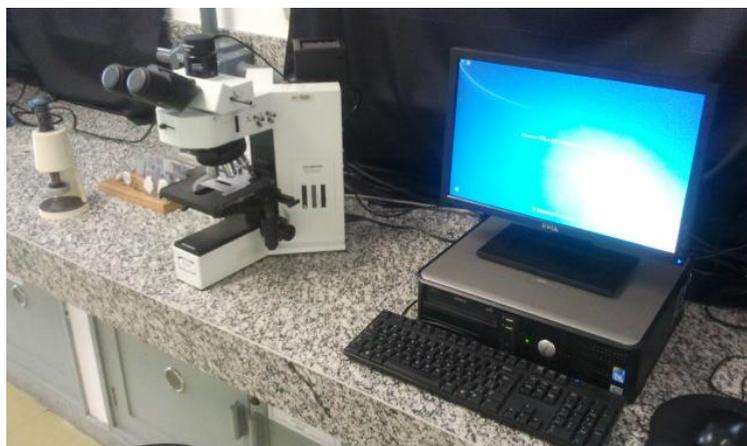
Figura 75: Microscópio óptico Olympus BX60M equipado com software de análise digital de imagens. Centro de Desenvolvimento de Materiais Metálicos da FEI (CDMatM-FEI).
