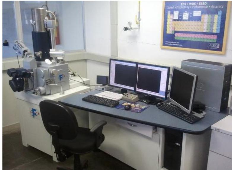
Figura 76: Microscópio eletrônico de varredura Camscan 3200LV equipado com sistema EDS Oxford Instruments modelo INCA X-act. Centro de Desenvolvimento de Materiais Metálicos da FEI (CDMatM-FEI).
