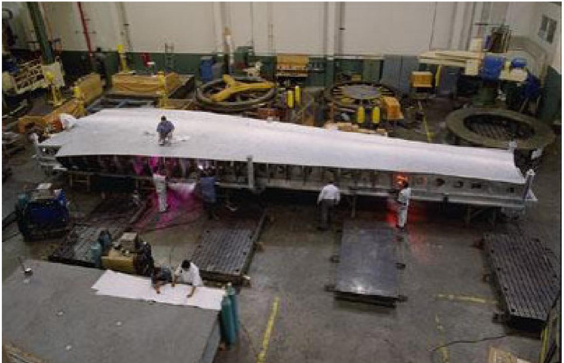
Figura 17 – Molde CAF para painel de asa do Gulfstream G-5
