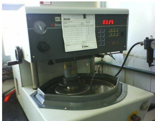
**Figura 3.11:** Equipamento automático de lixamento e polimento das amostras.
