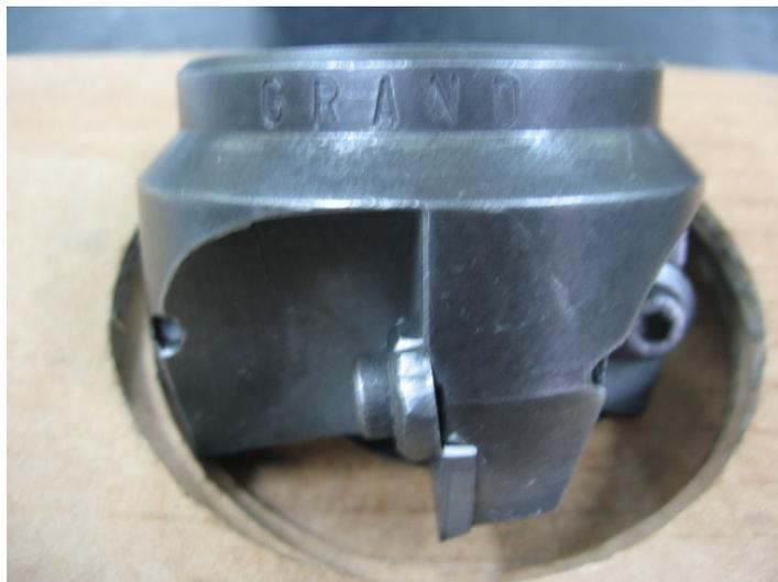
**Figura 3.4:** Ferramenta utilizada para a operação de desbaste.
