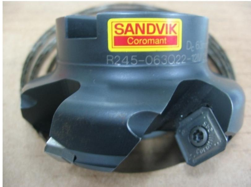
**Figura 3.5:** Ferramenta utilizada para a operação de acabamento.
