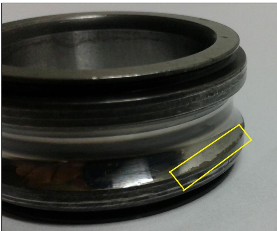
**Figura 88: Rolamento 04 - Pista Interna – Detalhe do desgaste**
