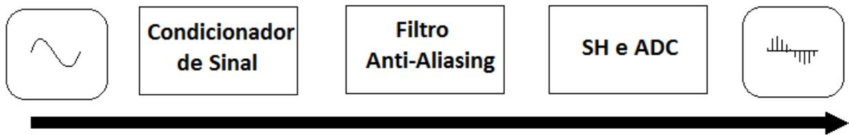
**Figura 1: Representação de um sistema de instrumentação e aquisição de dados**
