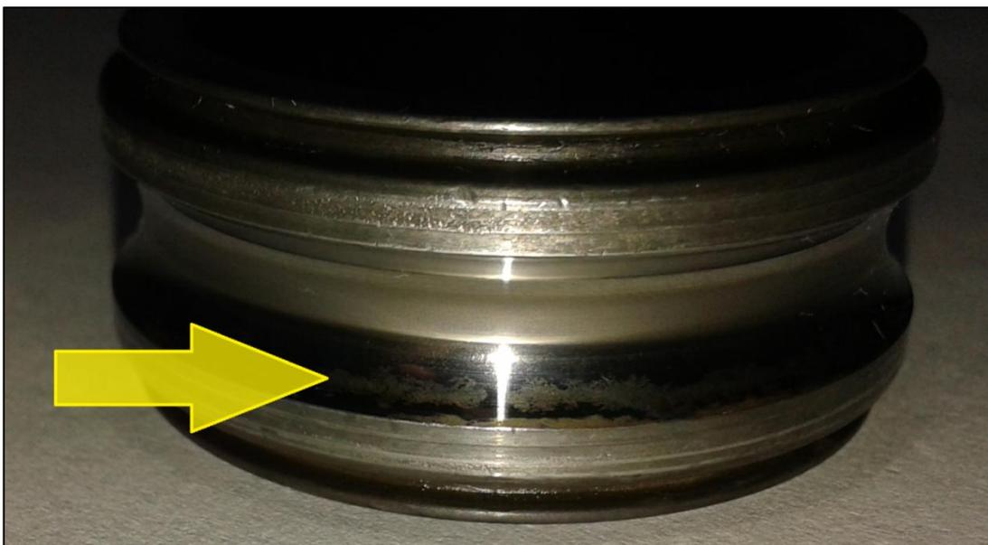
**Figura 87: Rolamento 04 - Pista Interna – Perda de Material**
