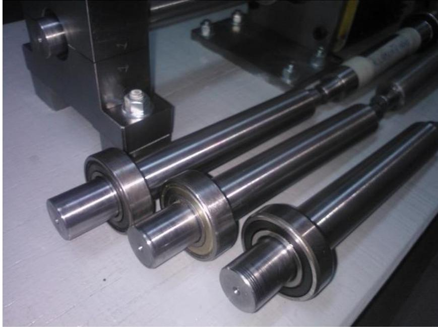
**Figura 56: Rolamentos 6205 que foram ensaiados – Eixos Independentes**
