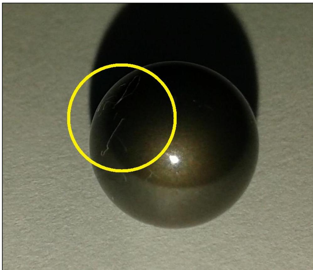
**Figura 86: Rolamento 04 – Elemento Rolante – Detalhe de Ranhura**
