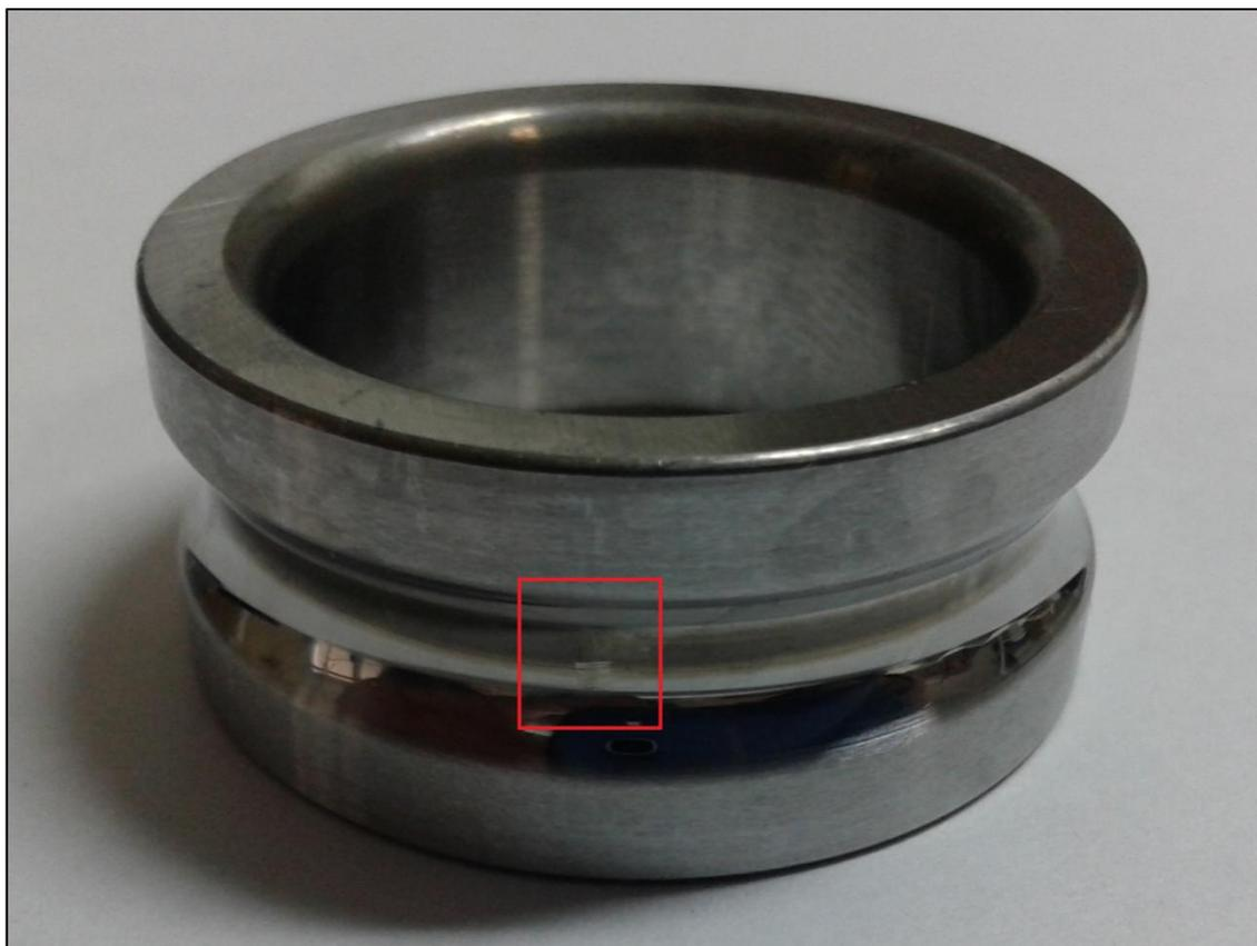
**Figura 82: Rolamento 05 - Pista Interna Falha B**
