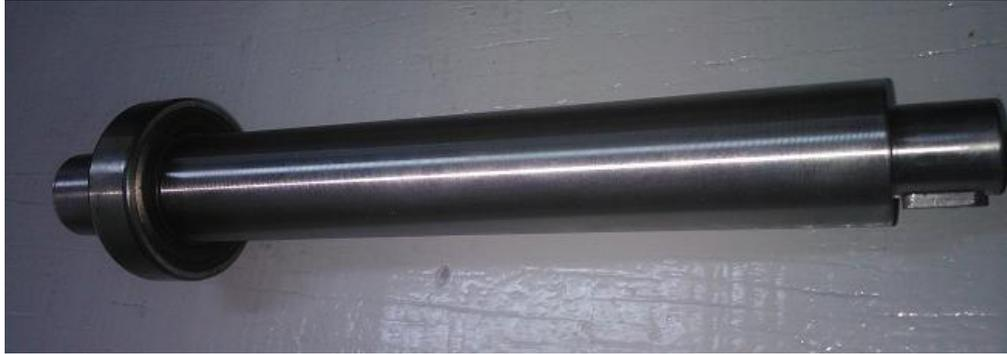
**Figura 62: Eixo com rebaixo no lado acoplado – Detalhe de chaveta**
