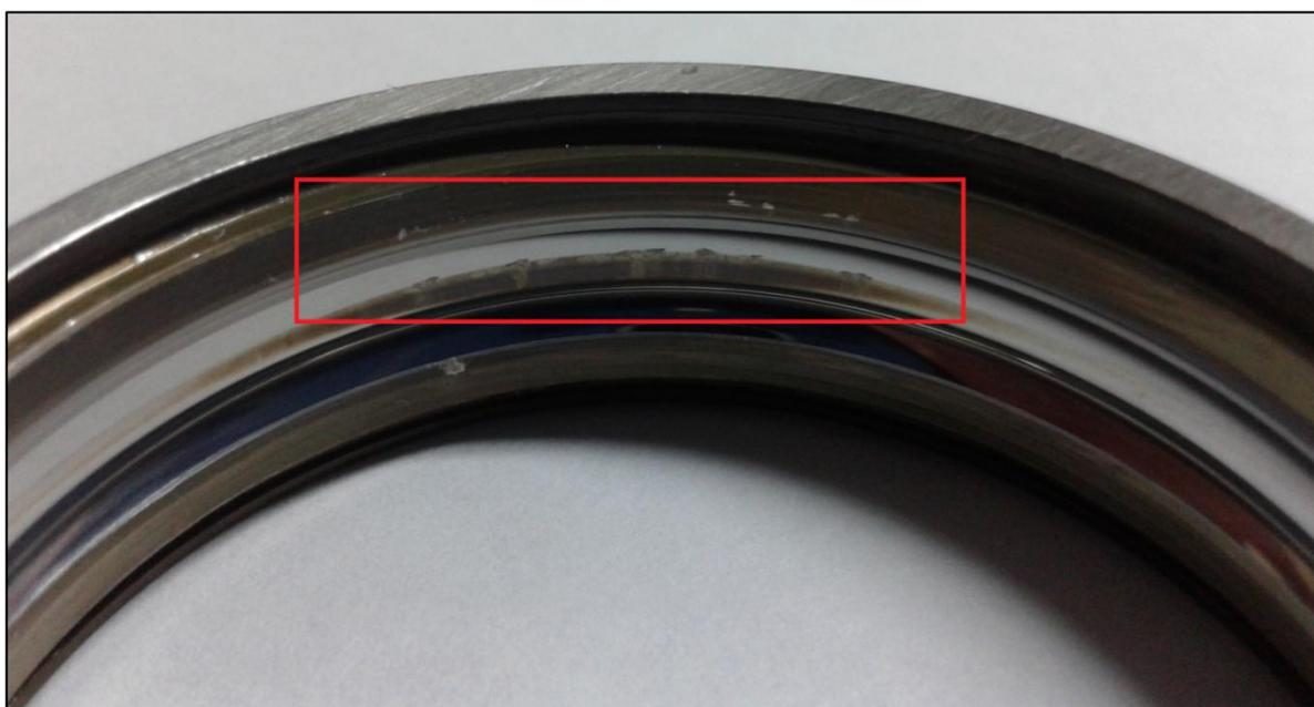
**Figura 83: Rolamento 05 - Pista Externa Início de desgaste**
