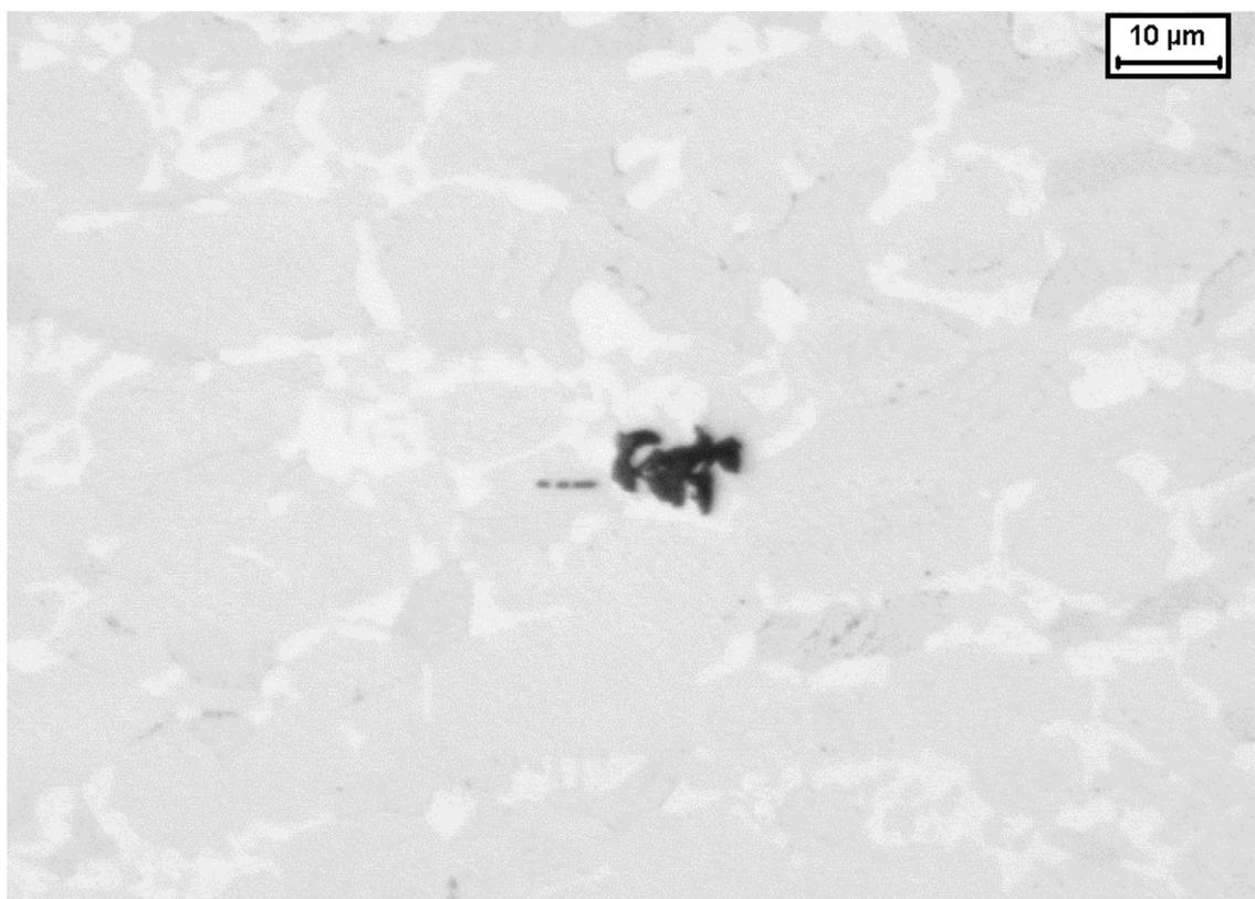
Figura 4.78. Amostra envelhecida por 900°C por 10 minutos após polarização cíclica em solução 0,6M NaCl.
