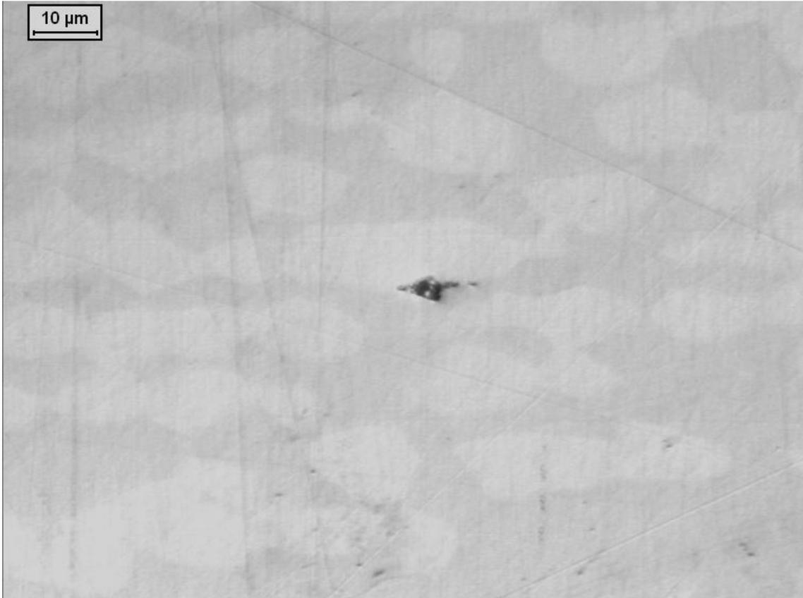
Figura 4.28. Amostra solubilizada após polarização cíclica em solução 0,6M NaCl.
