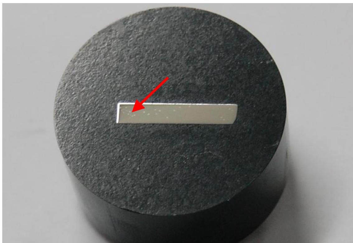
Figura 4.58. Superfície da amostra envelhecida por 850°C por 240 horas após polarização cíclica em solução 0,6M NaCl.
