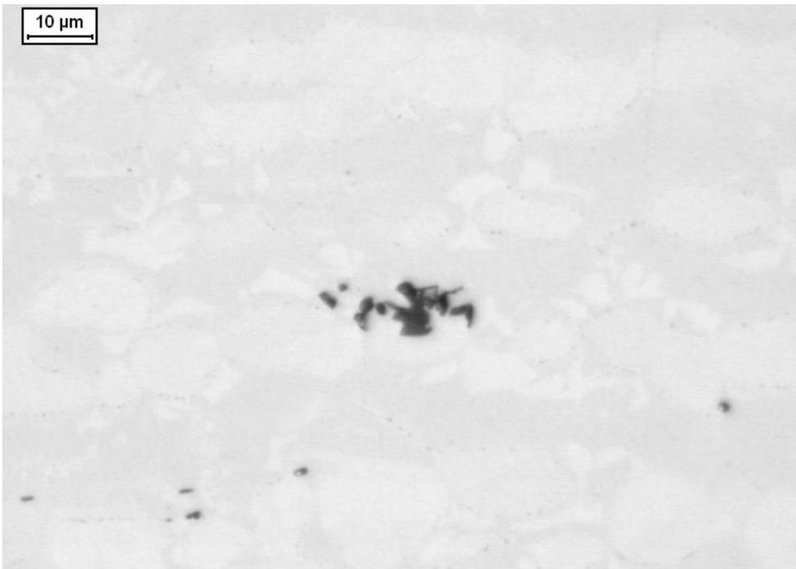
Figura 4.81 Amostra envelhecida por 900°C por 1 hora após polarização cíclica em solução 0,6M NaCl.
