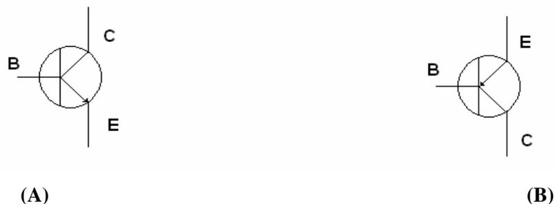
figura 2: símbolo para o transistor NPN (A) e o símbolo para o transistor PNP.
