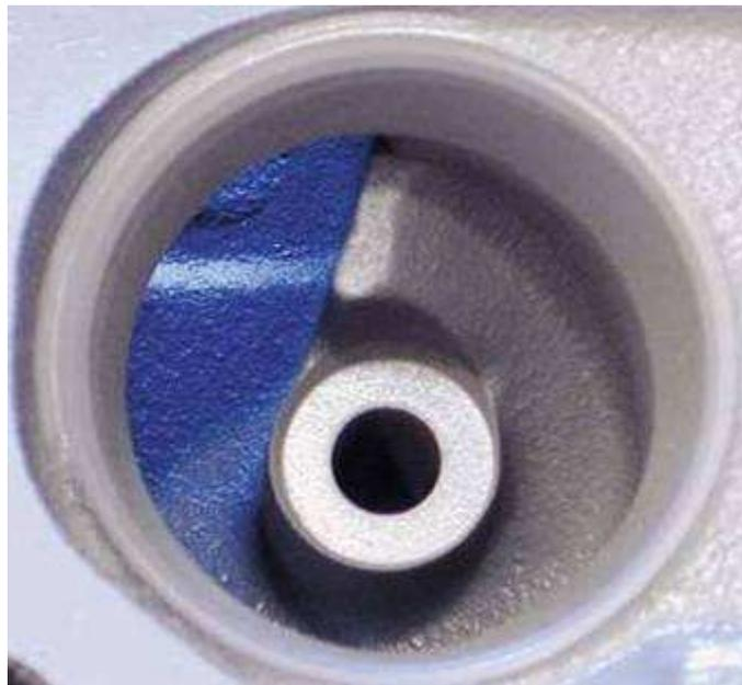
Figura 2.6 – Duto de admissão do cabeçote Vortec com geometria geradora de turbilhonamento
