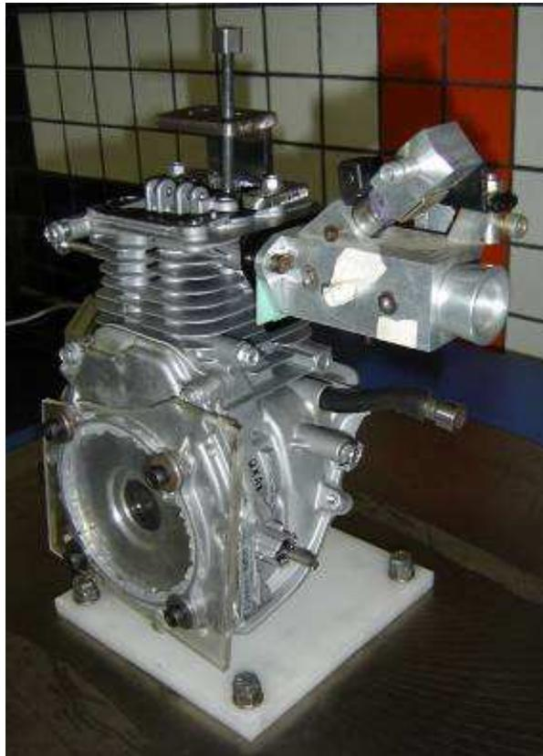
Figura 3.6 – Conjunto completo instalado no banco de fluxo.
