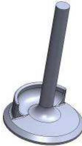
Figura 2.3 – Desenho de válvula com obstrução para geração de Swirl
