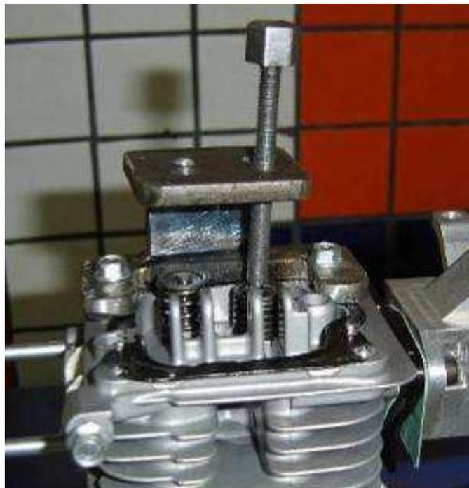
Figura 3.7 – Dispositivo de abertura da válvula.
