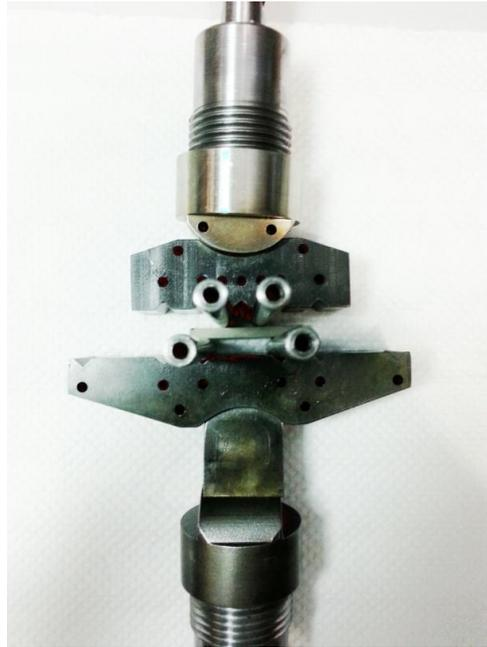
Figura 37 – Dispositivo utilizado para o ensaio de flexão em 4 pontos.
