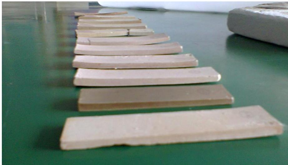
Figura 46 – Corpos de provas retangulares de diferentes concentrações (puro, 0,2% e 0,5%) de aditivo (manganês), obtidos através do molde metálico existente na instituição de ensino.
