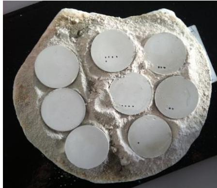
Figura 47 – Corpos de prova à verde conformados em formato e pastilhas.
