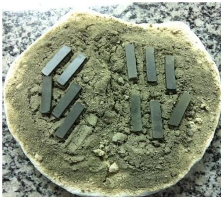
Figura 48 – Corpos de prova em barras de menores dimensões cortados de pastilhas de SnO<sub>2</sub> com diferentes concentrações de manganês (0,2% e 0,5%).
