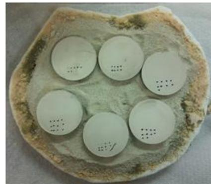
Figura 35 – Corpos de prova em pastilhas acomodados na camada de dióxido de estanho puro e dopado com concentração igual as do Cp's
