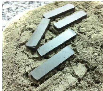
Figura 49 – Corpos de prova em barras de menores dimensões cortados de pastilhas de SnO<sub>2</sub> 0,5% de manganês.
