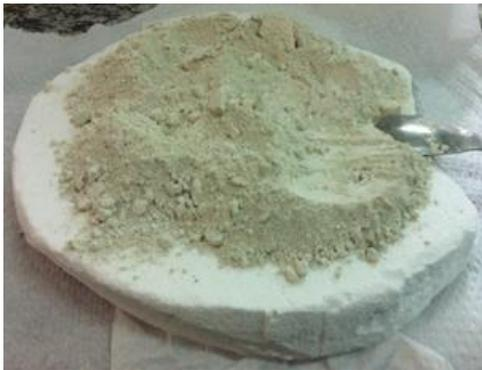
Figura 34 – Cobertura de dióxido de estanho aplicada à base de alumina
