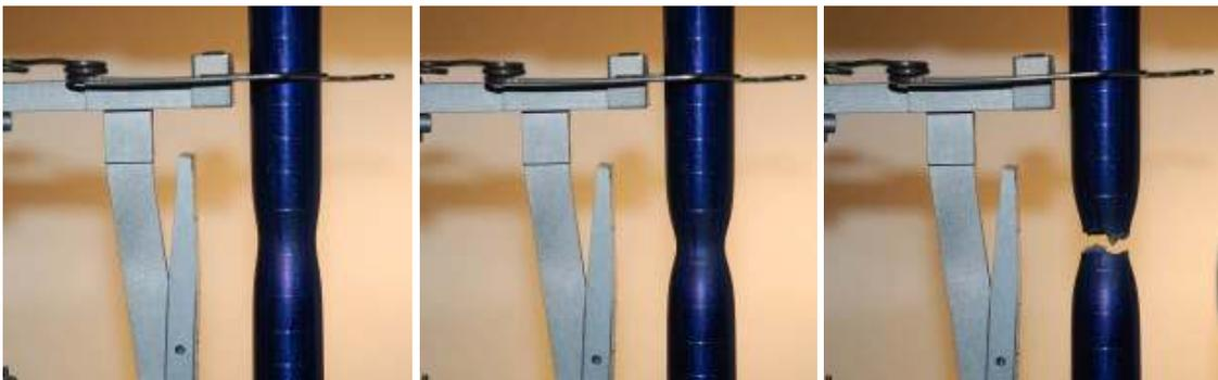
Figura 50: Etapas ilustrativas aleatoriamente selecionadas de um Ensaio de tração.
