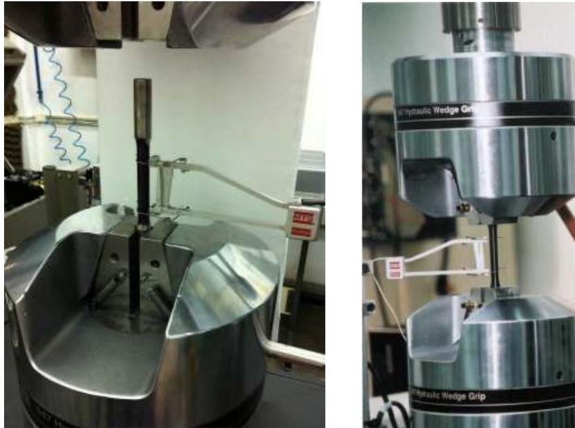
Figura 48: Fixação da amostra à máquina de ensaio do CDMatM-FEI e posicionamento do extensômetro
