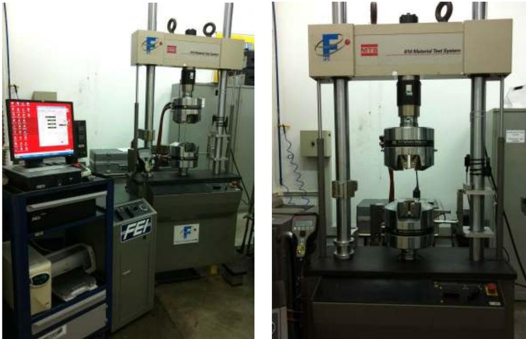
Figura 45: Fotos da máquina MTS 810 da FEI utilizada para a realização dos ensaios de tração deste trabalho.
