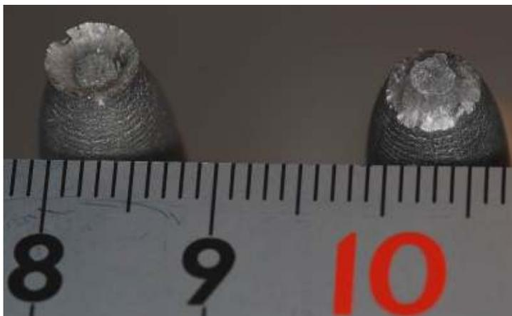
Figura 21: Fratura taça-cone de corpo-de-prova cilíndrico de Aço Inoxidável AISI 304 recozido ensaiado em tração uniaxial.
