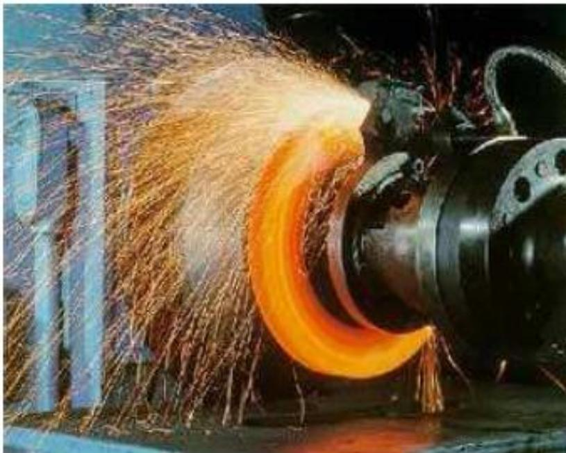
Figura 10 – Teste de Freio em Dinamômetro Inercial
