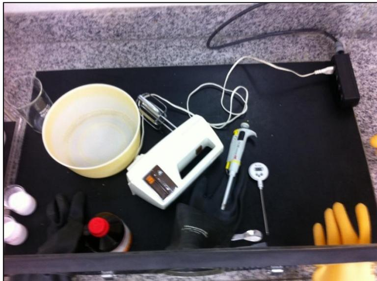
Figura 20 - Equipamentos dentro da "glovebox" para a preparação de espumas cerâmicas.
