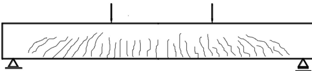
Utilizando a Equação (3) e Equação (4) podem ser utilizadas calcular as tensões principais e as direções em que elas ocorrem prevendo a inclinação das fissuras.
