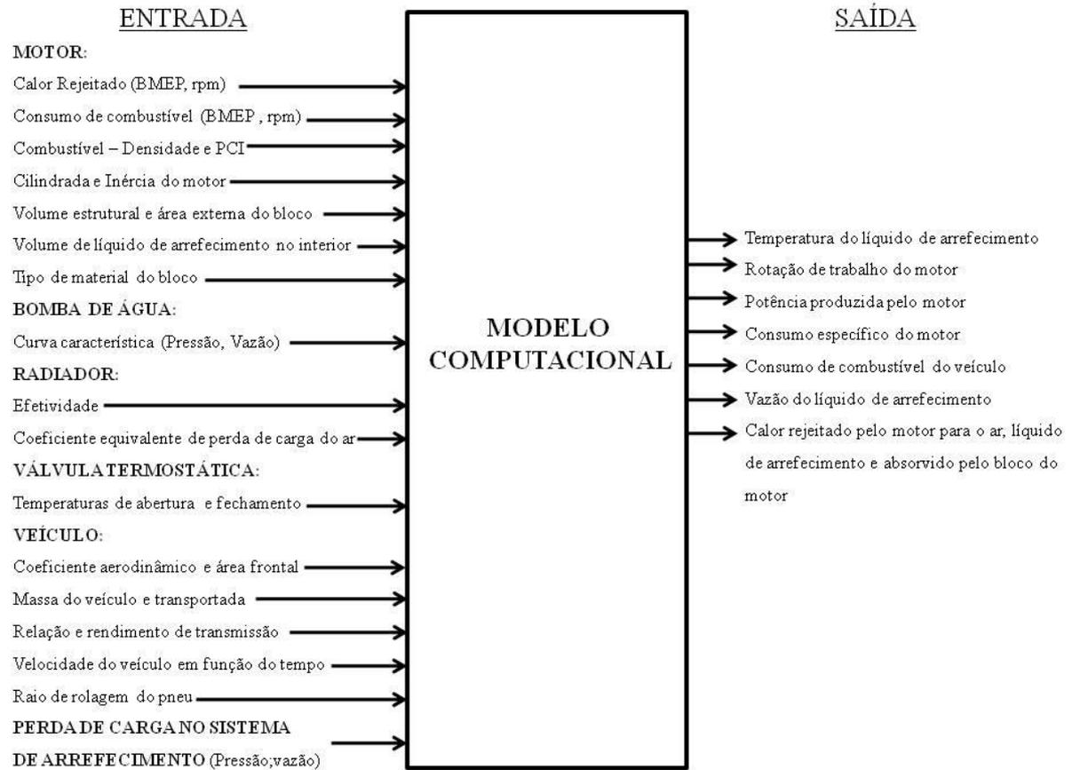
Figura 3.2 – Modelo esquematizado dos parâmetros de entrada e dados de saída para o modelo computacional
