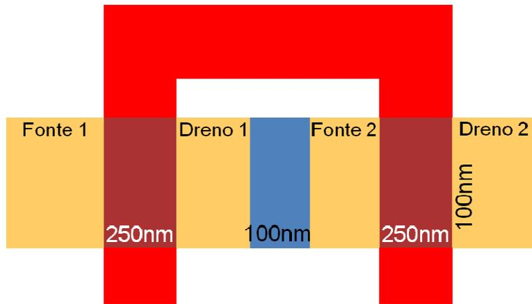
Figura 5.47 - Vista superior da topologia 2, ilustrando as regiões sensíveis e a separação entre os dispositivos, proporcionada por 100nm de SiO<sub>2</sub>
