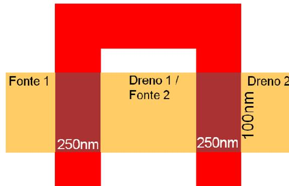
Figura 5.49 - Vista superior da topologia 3, ilustrando as regiões sensíveis e a separação entre os dispositivos, proporcionada por 100nm de SiO<sub>2</sub>
