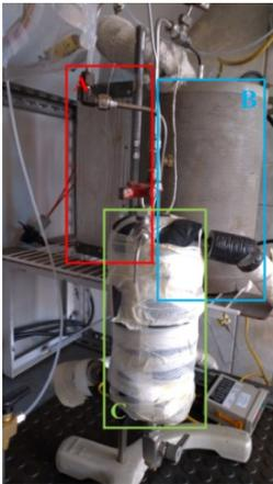
Legenda: A (cor vermelha) representa o pré-aquecedor; B (cor azul) representa o reator; C (cor verde) representa o condensador/separador.
