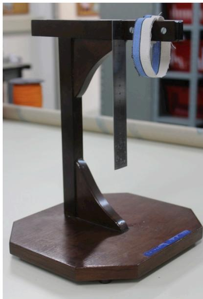
Figura 25 - Aparelho de caimento tipo laço
