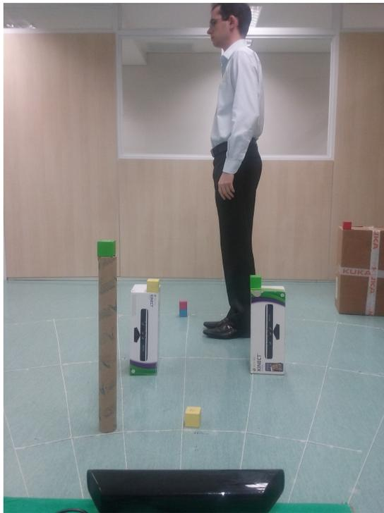
(a) Perspectiva do Kinect (Agente Robô 1) de um Agente Humano (Agente 2) rotacionado  $270^\circ$  em relação ao sensor Kinect
