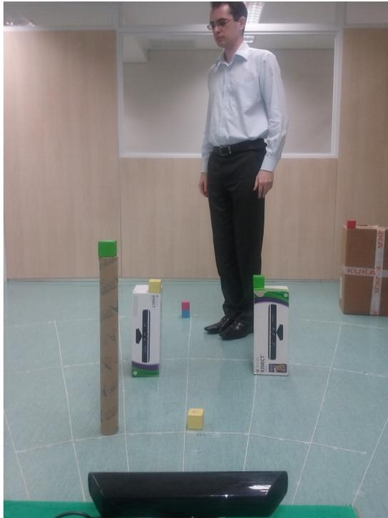
(a) Perspectiva do Kinect (Agente Robô 1) de um Agente Humano (Agente 2) rotacionado  $225^\circ$  em relação ao sensor Kinect
