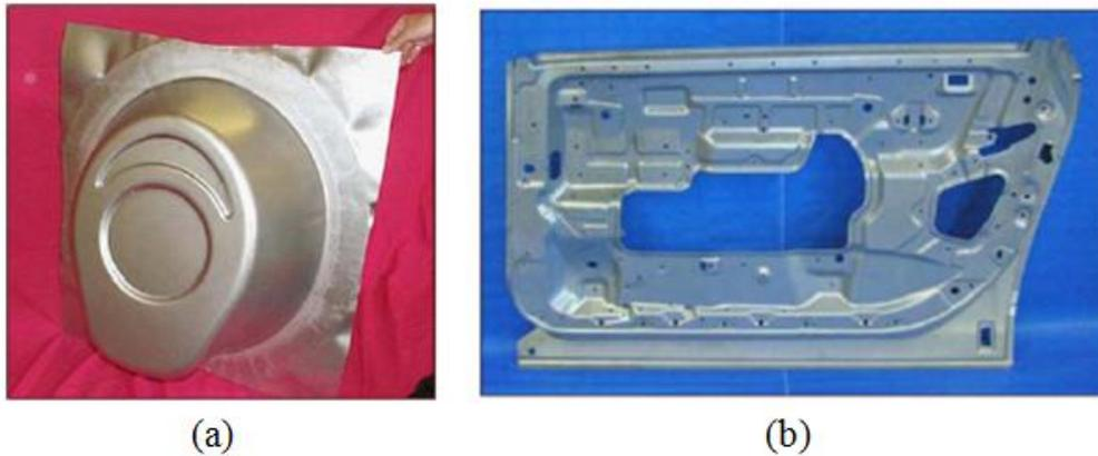
Figura 8 – Peças obtidas por meio do processo de conformação superplástica . (a) Componente aeroespacial, (b) porta de um automóvel.
