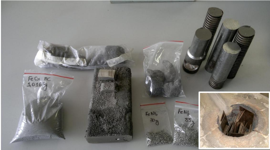
Figura 64 - Carga para a fusão.
