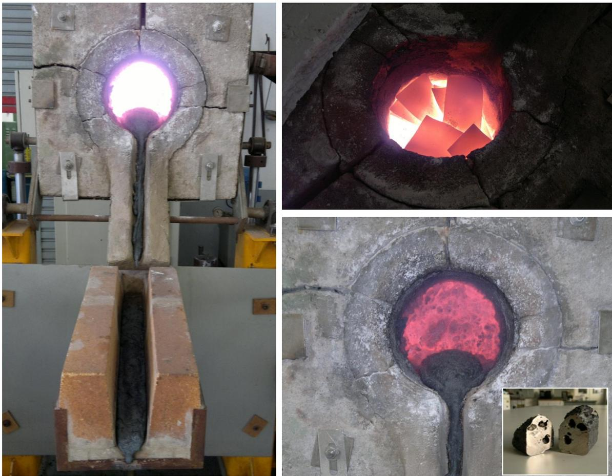
Figura 77 - Obtenção de um terço do lingote projetado em função da oxidação ocorrida.
