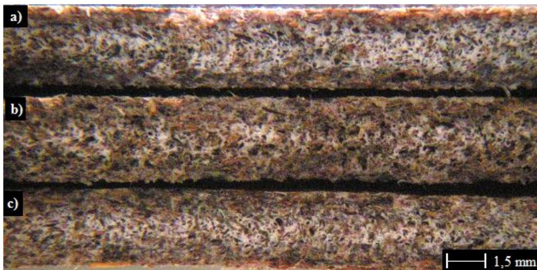
Figura 76: Fotografia das superfícies fraturadas em a) 35Hz, b) 5 Hz c) 35 Hz refrigerado com amplitude de deformação de 0,01766.
