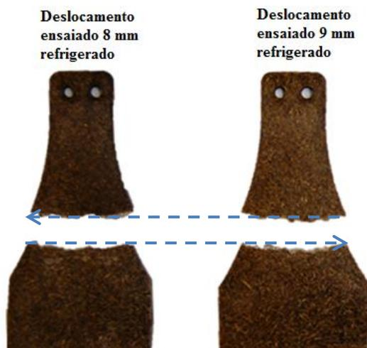
Figura 100: Posição da fratura dos ensaios a 8 mm e 9 mm com e sem refrigeração, respectivamente.
