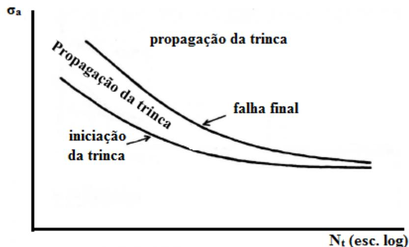
Figura 19: Curva de amplitude de tensão por número de ciclos com as diferentes etapas da falha por fadiga. Fonte: Suresh, 1998.
