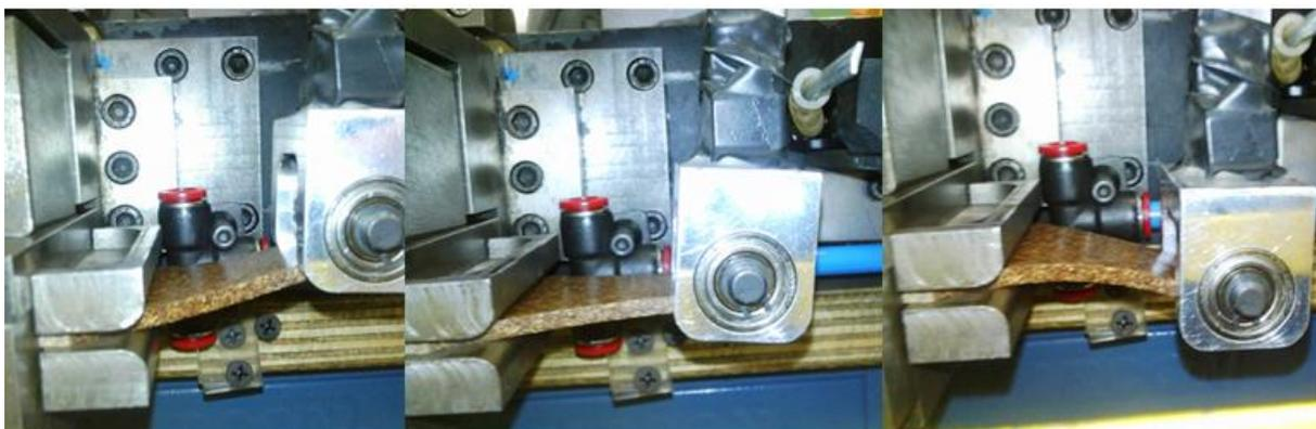
Figura 197: Detalhe do corpo de prova sendo ensaiado em flexão alternada.
