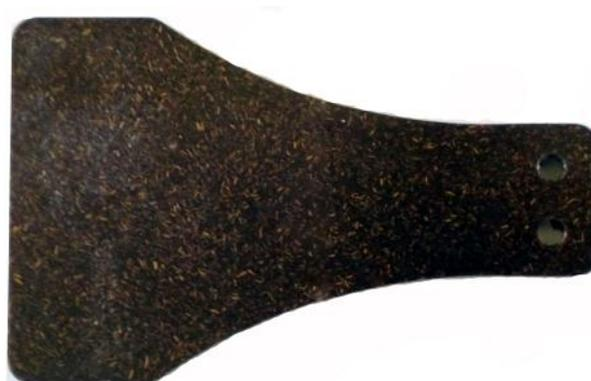
Figura 181: Corpo de prova de flexão PP com fibra de coco.
