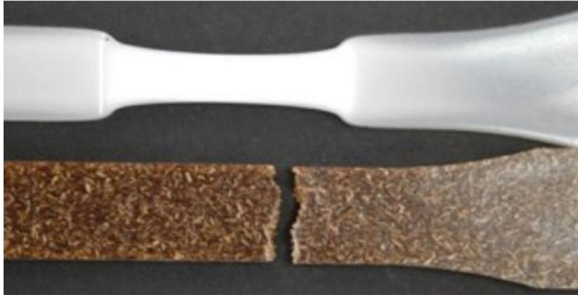
Figura 50: Comparação dos tipos de falha do PP puro (fadiga com efeito de aquecimento) e o compósito de fibra de coco (fadiga mecânica).
