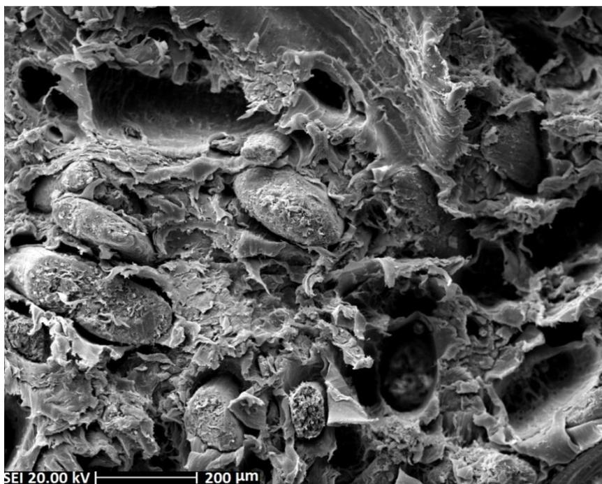
Figura 84: Fractografia em MEV: Detalhe da região central da superfície fraturada no ensaio realizado a 35 Hz e amplitude de deformação de 9mm.
