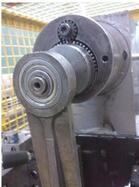
Figura 59: Mecanismo de variação do deslocamento imposto ao corpo de prova.
