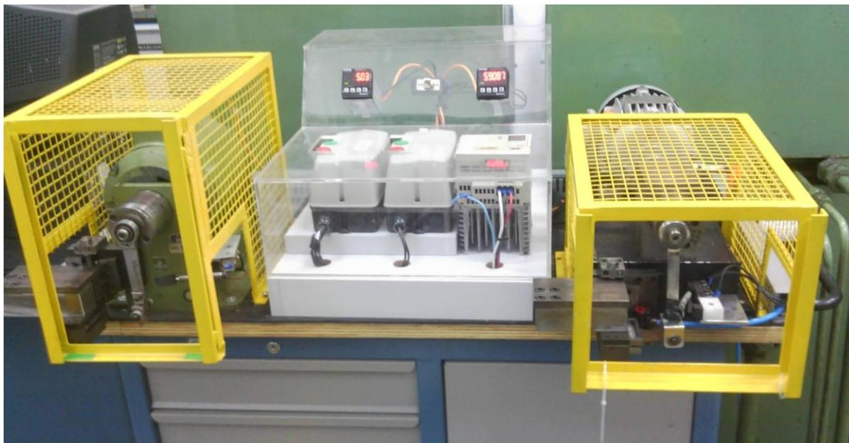
Figura 195: Nova máquina de ensaios totalmente montada (a direita) ao lado da máquina original do laboratório.
