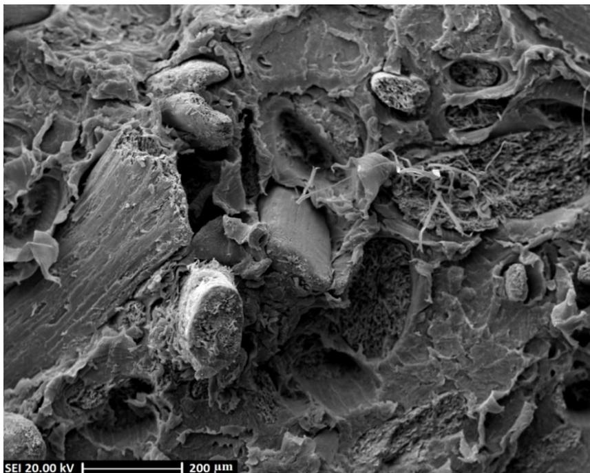
Figura 79: Fractografia em MEV: Visão detalhada da região central da superfície fraturada no ensaio realizado a 5 Hz e amplitude de deformação de 9 mm.
