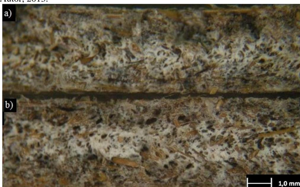
Figura 112: Fotografia das superfícies fraturadas em a) 15 Hz, b) 35 Hz com amplitude de deformação de 0,01318.
