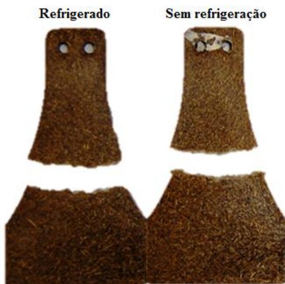
Figura 77: Diferença na posição da falha dos ensaios com e sem refrigeração a 35 Hz e deslocamento de 9 mm.
