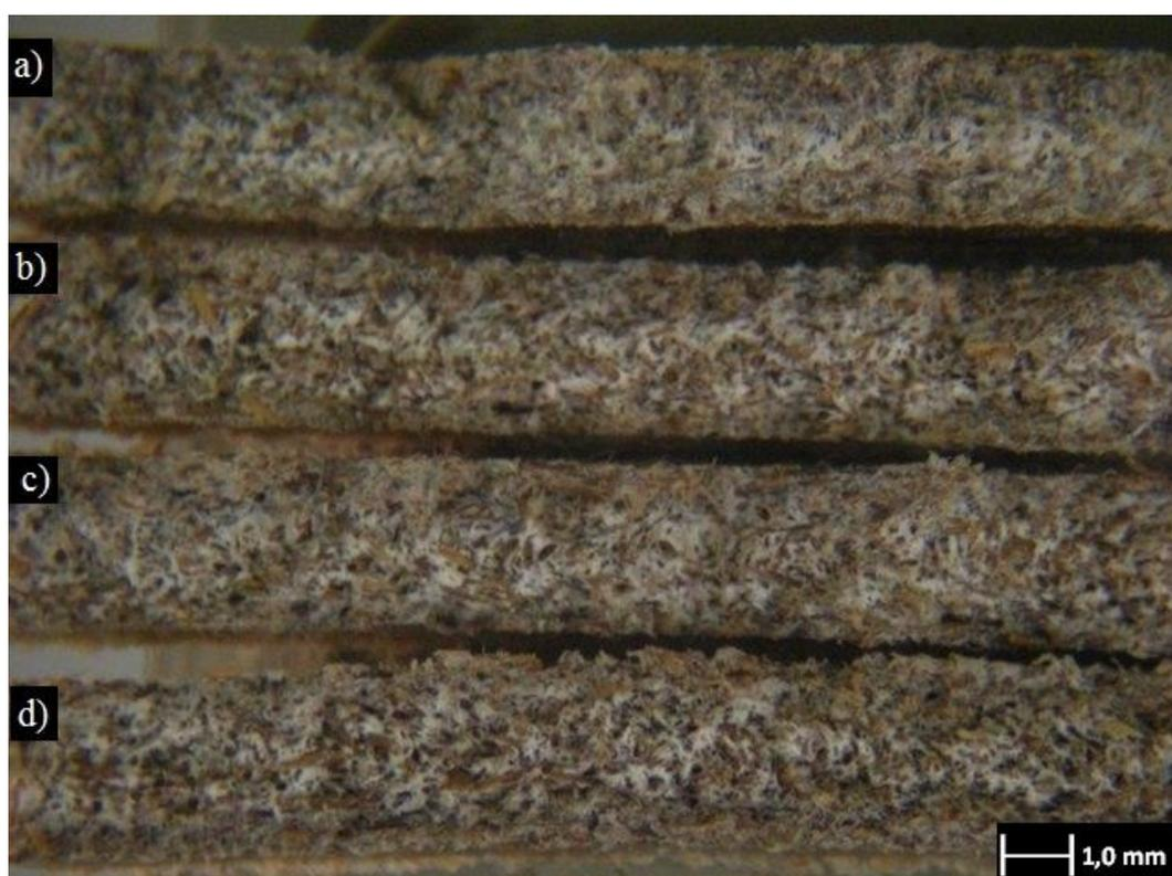
Figura 103: Fotografia das superfícies fraturadas em a) 5Hz, b) 20 Hz (43 mil ciclos) c) 25 Hz (1452 mil ciclos) d) 35 Hz com amplitude de deformação de 0,01430.
