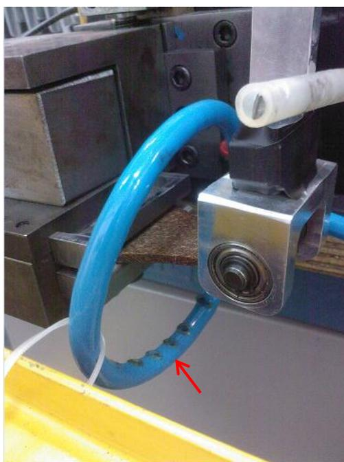
Figura 62: Resfriamento do corpo de prova.
