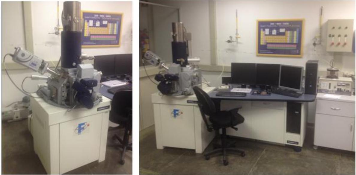
Figura 25 - Microscópio eletrônico de varredura CamScan CS 3200 LV
