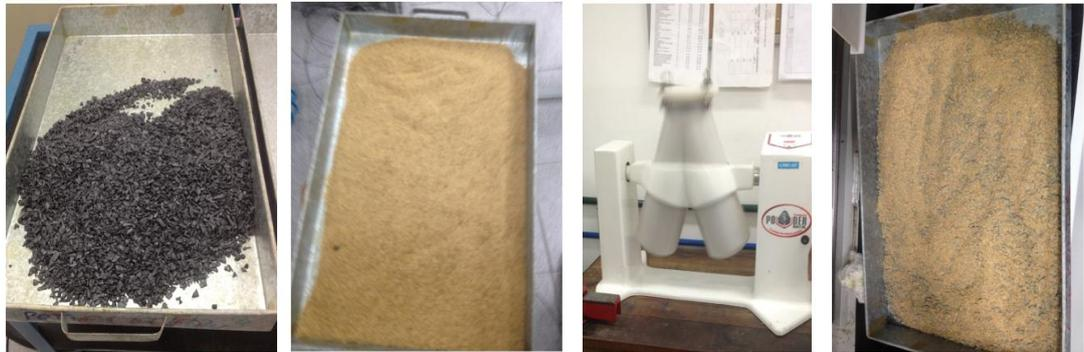
Figura 13 - Processo de mistura do PP tenacificado e Fibra de Bambu em misturador tipo Y e mistura final
