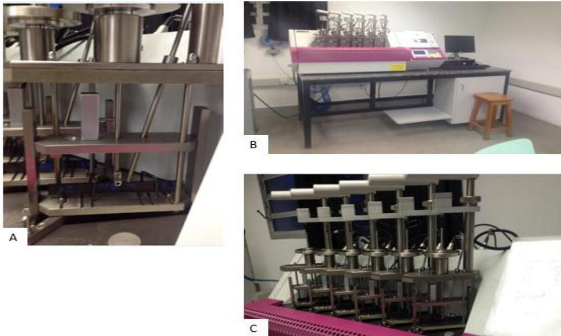
Figura 24 - Aparelho para ensaio HDT CEAST HDT 6 Vicat em a) detalhe do corpo de prova posicionado para teste, b) vista geral da máquina, c) detalhes do equipamento antes do ensaio
