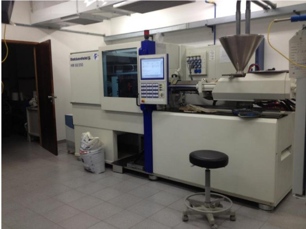
Figura 15 - Injetora Battenfeld HM 60/350 utilizada para a injeção dos corpos de prova
