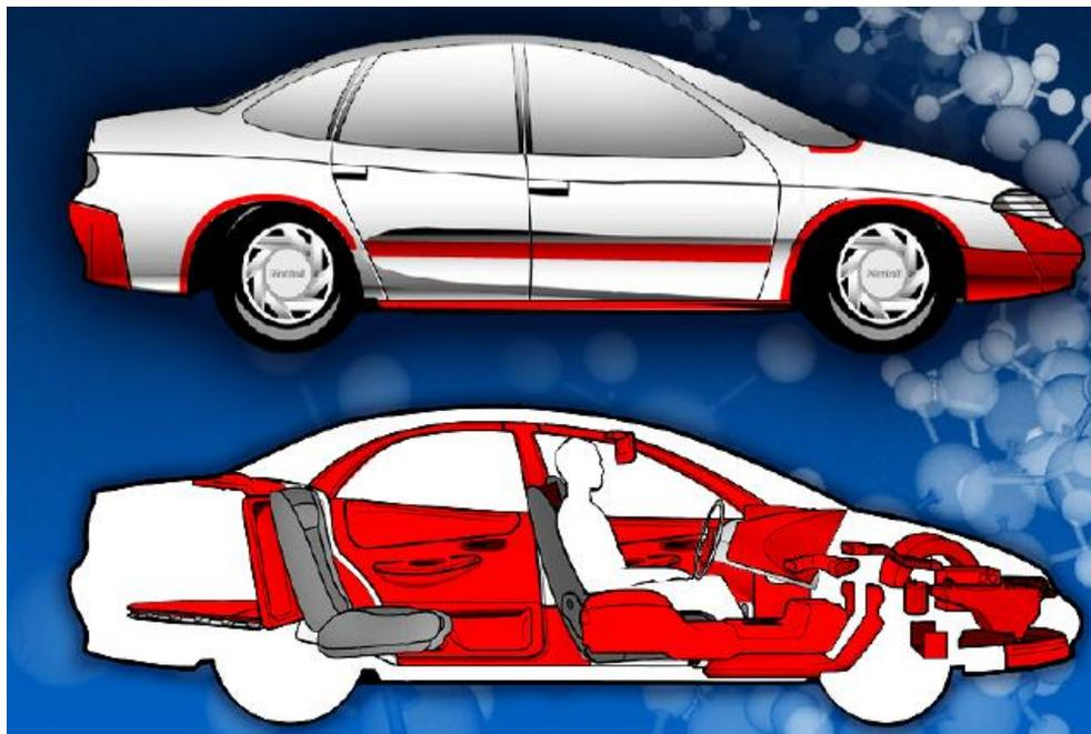
Figura 2 - Utilização de PP em veículos leves comerciais, demonstrado nas peças em vermelho
