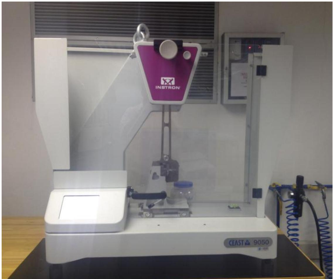
Figura 20 - Equipamento para ensaio de impacto Charpy
