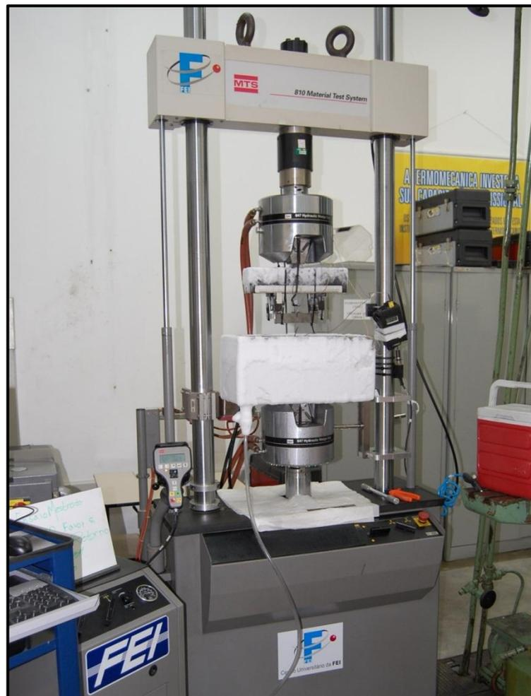
Figura 56 – Foto da máquina MTS do CDMatM-FEI utilizada para a realização dos ensaios de flexão em três pontos. Temperatura foi mantida entre  $-72^\circ\text{C}$  a  $-78^\circ\text{C}$  com variação inferior de  $\pm 1^\circ\text{C}$ .
