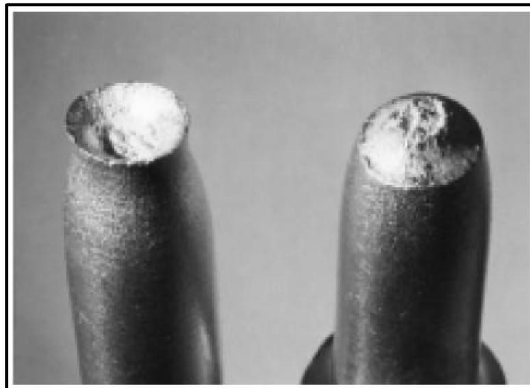
Figura 28 – Fratura taça-cone em um corpo de prova de alumínio dúctil.
