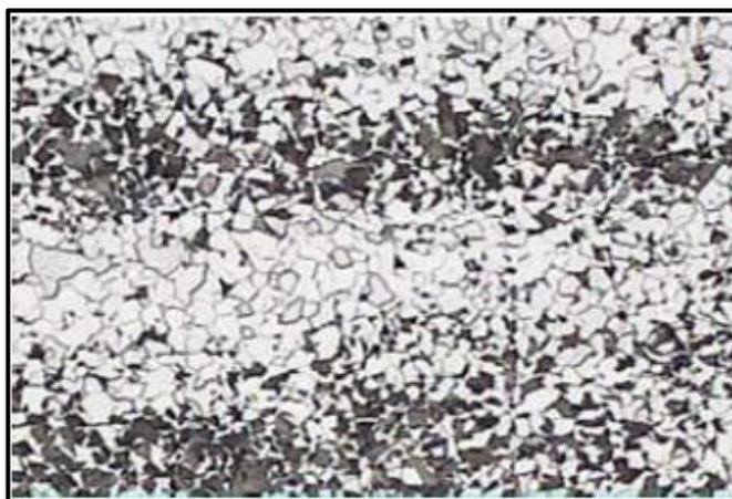
Figura 1 – Microestrutura ferrita-perlita de uma chapa de aço ASTM A516 Gr. 70. O constituinte da cor clara representa a ferrita e o constituinte escuro representa a perlita. (Bandeada – aumento 100x). Ataque de nital 2%.
