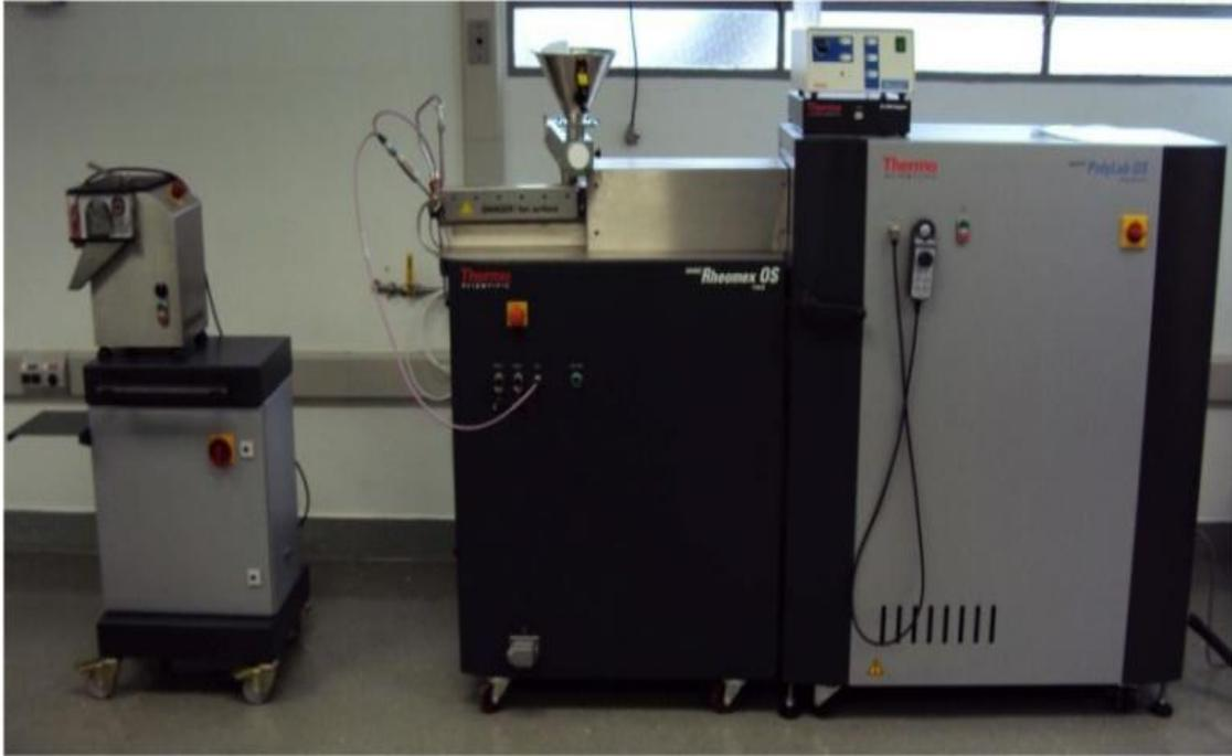
Figura 33 - Extrusora modelo Haake Rheomex PTW 16
