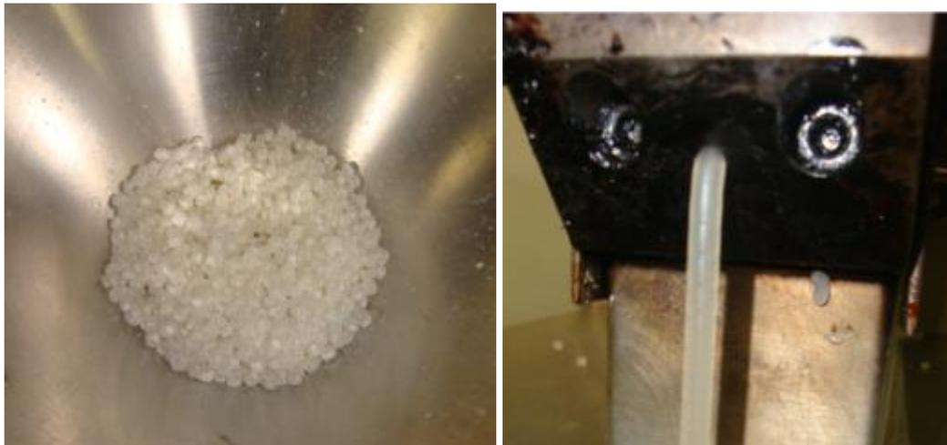
Figura 34 - a) Mistura no funil alimentador da extrusora / b) compósito extrudado
