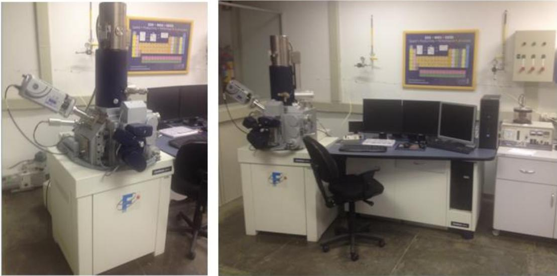
Figura 41 - Microscópio eletrônico de varredura CamScan CS 3200 LV
