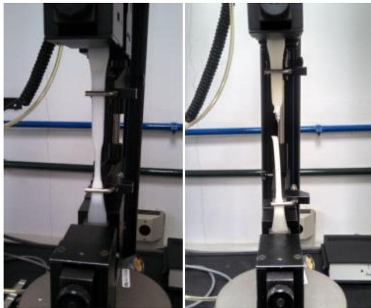
Figura 36 - (a) Comportamento típico de um corpo de prova polimérico submetido a tração. (b) Término do ensaio de tração após a ruptura do corpo de prova.
