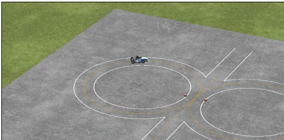
Figura 84 – Modelo da Pista, “Skid pad” no Carsim.
