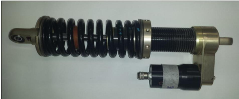
Figura 47 – Amortecedor do tipo Penske PS-78PB.
