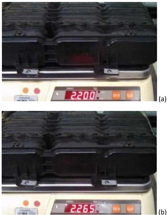
Figura 15 – cânister completamente purgado (a) e após a adsorção de COVs
