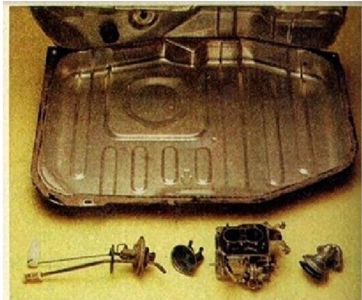
Figura 5 – tanque de combustível feito de chapas de aço, bomba e carburador sem nenhum sinal de corrosão provocada pelo álcool.
