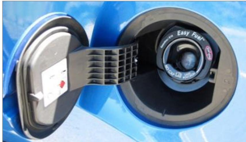
Figura 09 – automóvel dotado de sistema “*capless*”, ou sem tampa do bocal de abastecimento.
