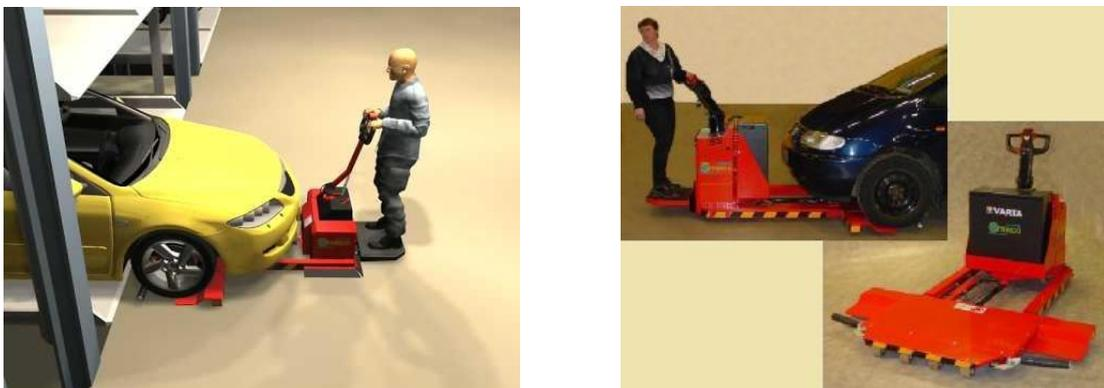
Figura 13 – trator (ou rebocador) elétrico usado em laboratórios de emissões.
