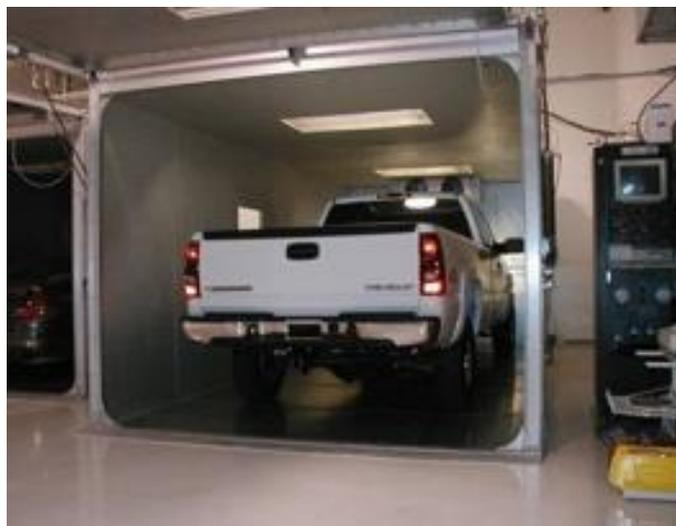
Figura 4: à esquerda, SHED fechada; à direita, SHED aberta com veículo em seu interior.
