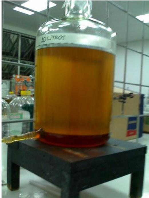
**Figura 3.13** – Garrafão para decantação - Laboratório de Engenharia Química – FEI
