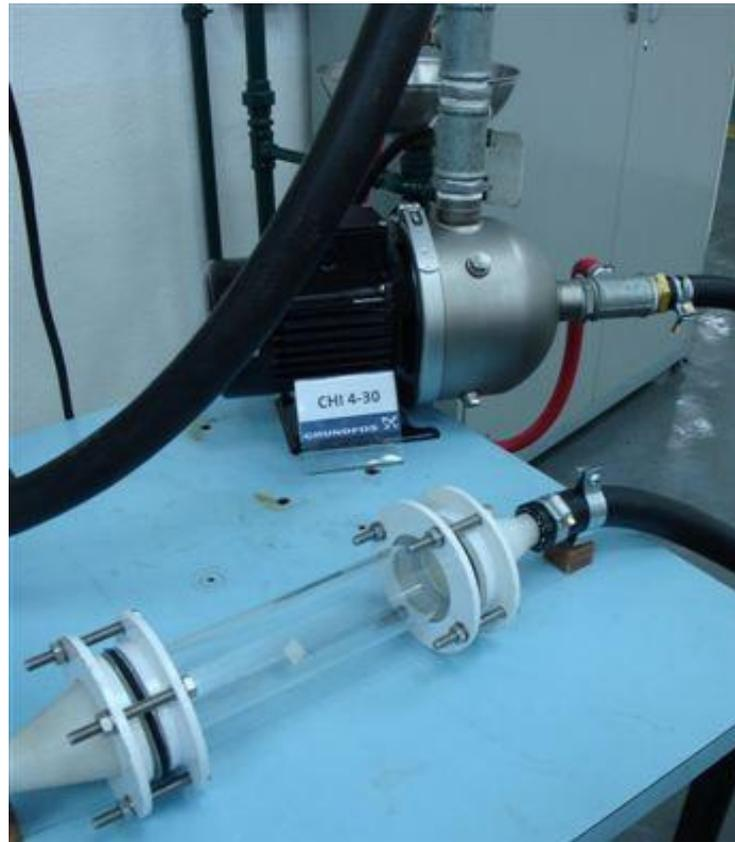
**Figura 3.10** – Bomba CHI 4 – 30 da Grundfos e trecho em borossilicato.
