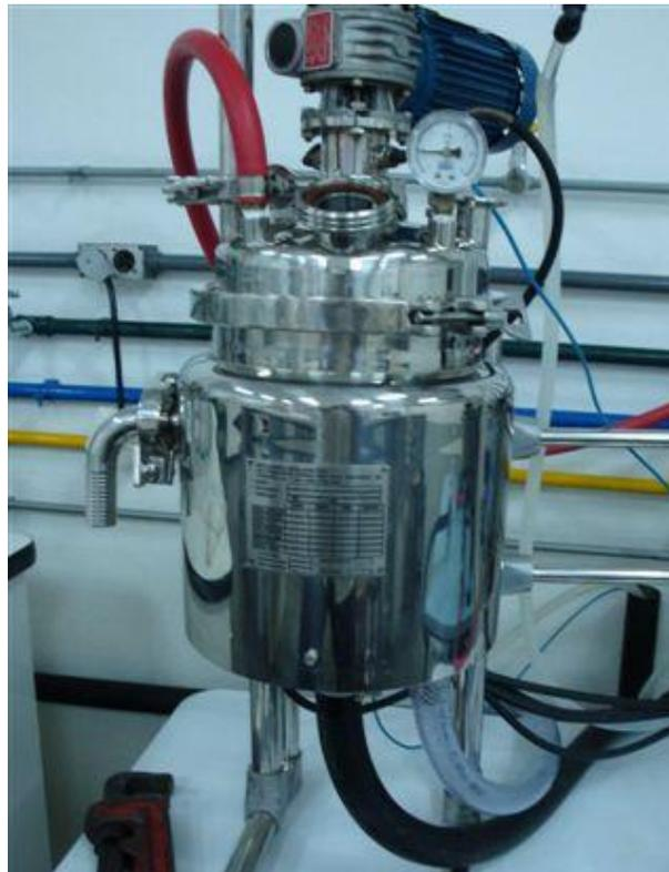
**Figura 3.7** – Adaptações efetuadas no reator para entrada e saída da mistura.
