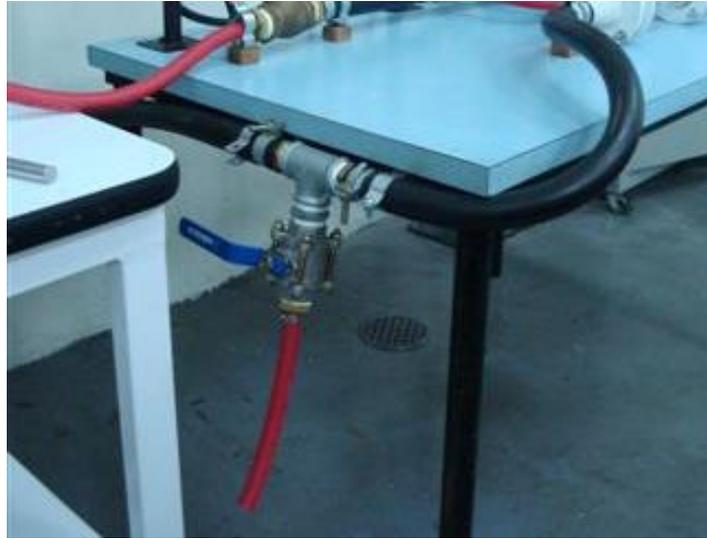
**Figura 3.8** – Válvula de esfera para retirada de amostras.
