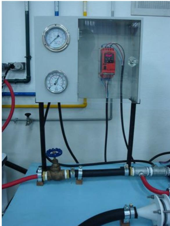
**Figura 3.11** – Manômetros, variador de frequência e válvula de controle de fluxo.
