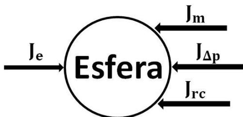
Figura 44 – Diagrama de corpo livre para deslocamento da esfera
