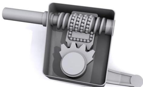
**Figura 4 – Sistema de direção com esferas recirculantes**
