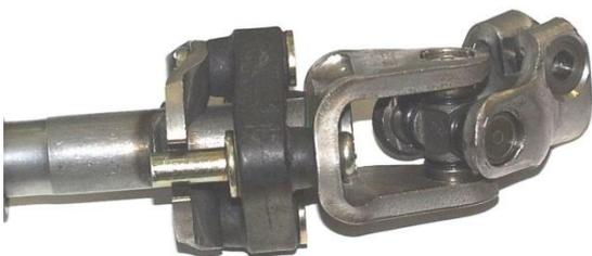
**Figura 25 – Junta elástica**
