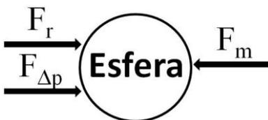
**Figura 43 – Diagrama de corpo livre para deslocamento da esfera gerado pelo fluxo**
