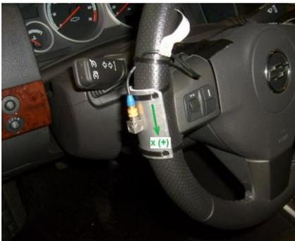
Figura 52 – Foto da localização de um dos acelerômetros
