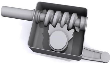
**Figura 3 – Sistema de direção Setor/Sem-Fim**
