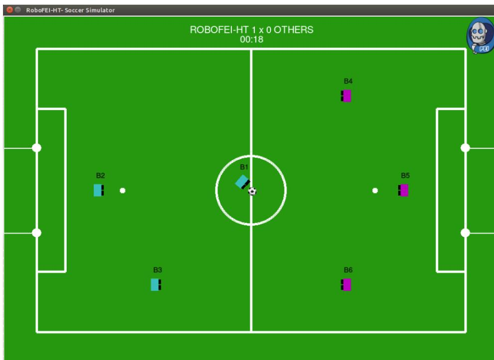
Figura 42 – Experimento para medir a fidelidade do simulador com relação à uma situação real
