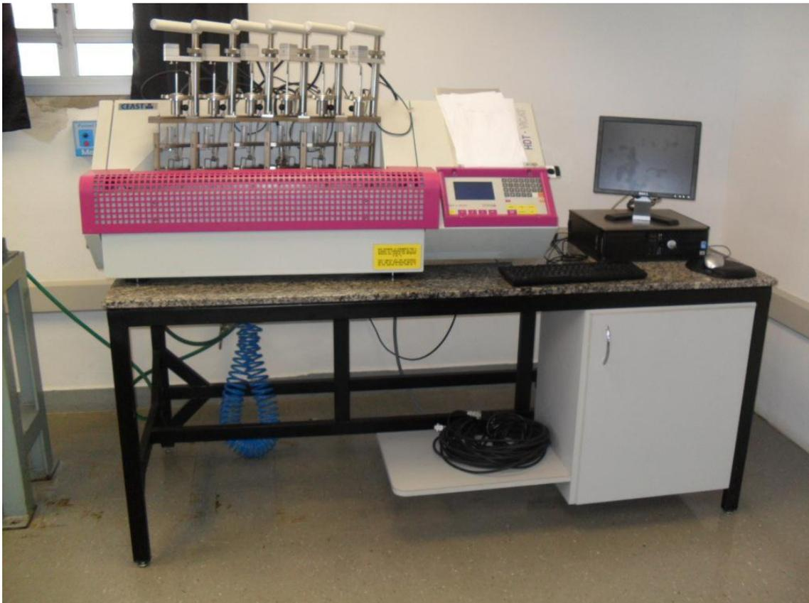
Figura 27 – Aparelho para ensaio HDT CEAST HDT 6 Vicat.
