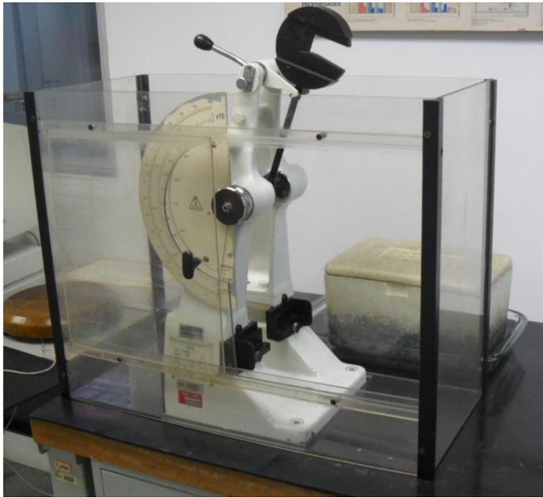
Figura 25 – Máquina analógica Charpy VEB Werkstoff Prüfmaschinen Leipzig, para ensaios de impacto
