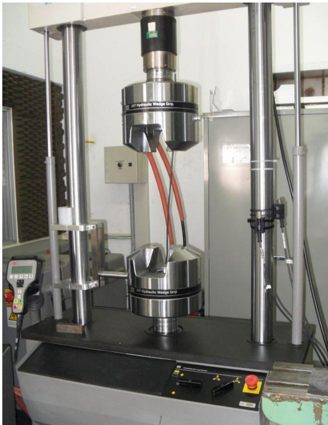
Figura 26 – Máquina de ensaios mecânicos MTS 810 – 250 kN
