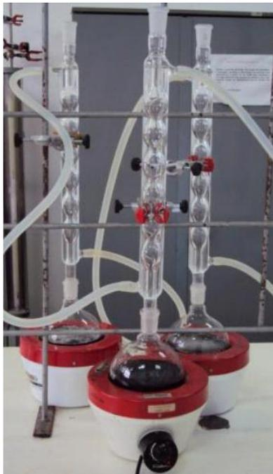
Figura 28 – Aparelhagem para solubilização de compósitos com uso de xileno.
