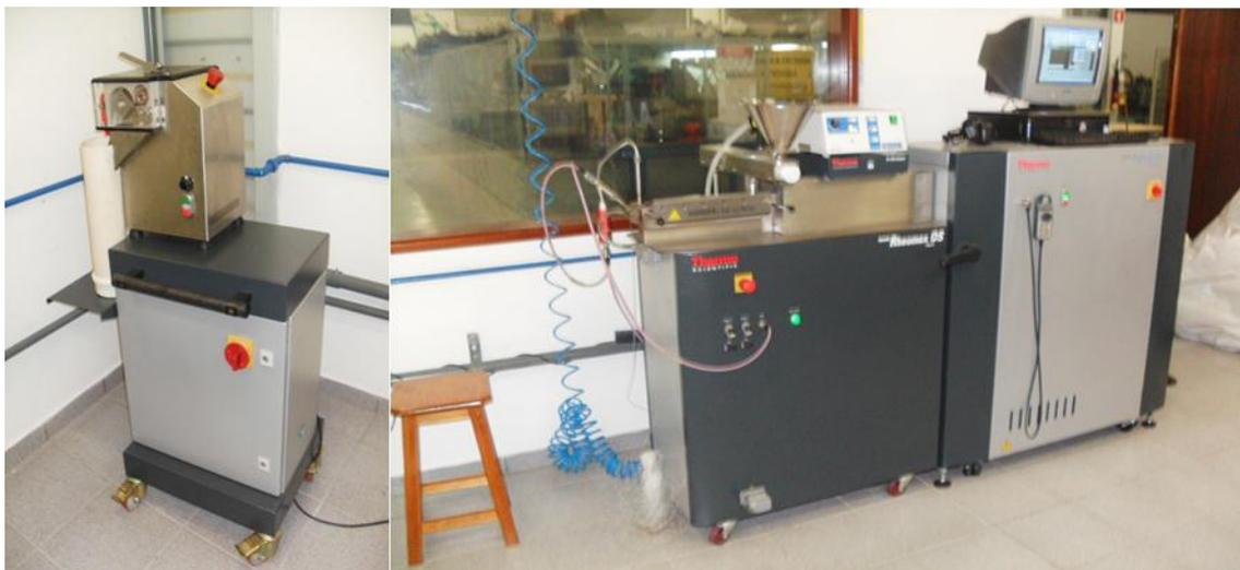
Figura 21 – Peletizador tipo moinho de facas e extrusora dupla rosca HAAKE PolyLab
