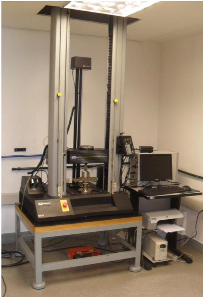
Figura 24 – Máquina Universal de Ensaio Istron 5567
