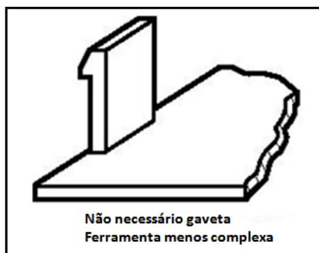
Figura 64: Sistema de clipe menos complexo que não necessitada da utilização de gaveta na ferramenta. Fonte: BAYER, 2001
