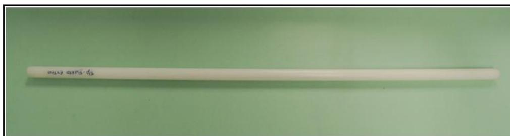
Figura 75: Barra de PA-6 com diâmetro de 25,4 mm (1 polegada) cortada com um metro de comprimento para posterior retirada de espécimes para ensaios mecânicos. Fonte: autor
