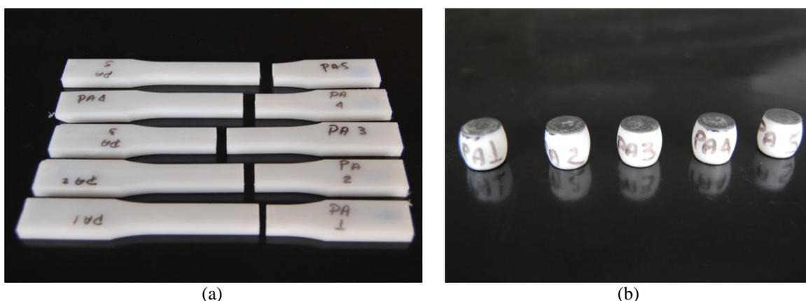
Figura 88: Corpos-de-prova de PA-6 ensaiados em (a) tração e (b) compressão. Fonte: Autor
