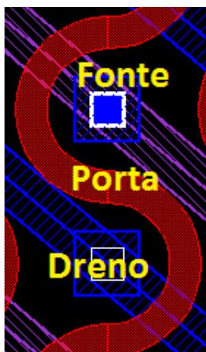
Figura 29 – Exemplo de uma célula básica do MOSFET *Wave*.
