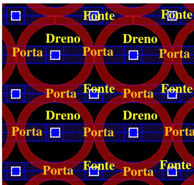
Figura 27 – Um exemplo de leiaute utilizando estrutura de MOSFETs circulares com sobreposição de portas.
