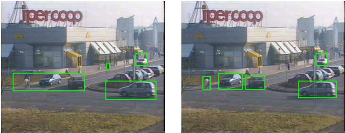
Figura 2.22: Aplicação do algoritmo de detecção de objetos em movimento. A esquerda nota-se uma detecção errada dos objetos, enquanto que a direita a localização é correta devido a supressão das sombras.
