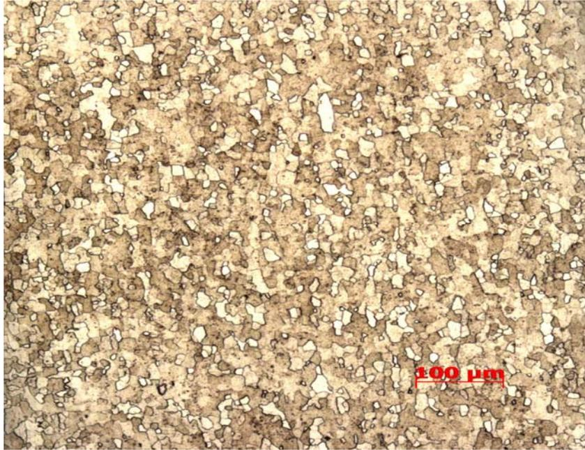
Figura 22 - Microestrutura da liga de aço em estudo - IF. Ataque nital
