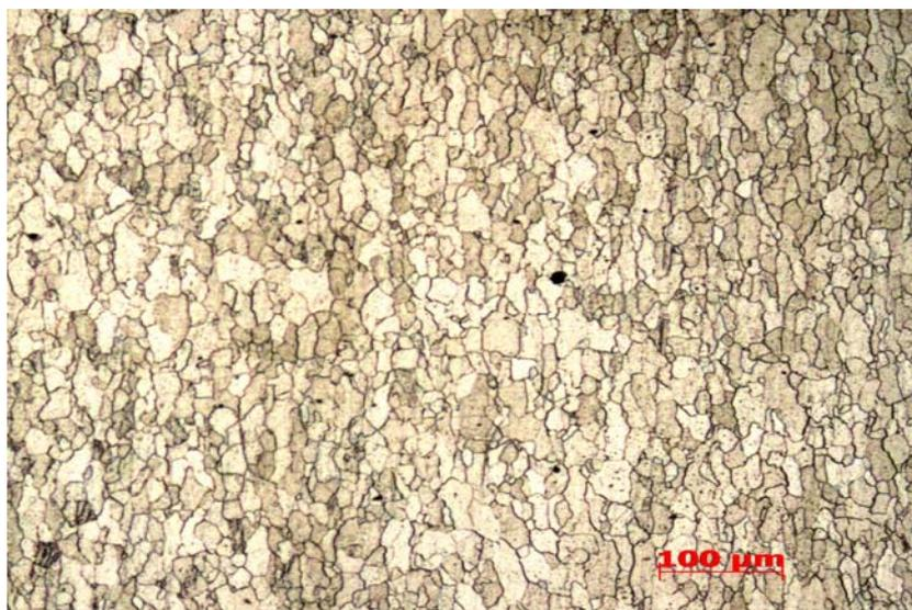
Figura 21 – Microestrutura da liga de aço em estudo – ELC. Ataque nital.
