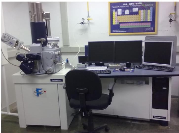
Figura 24. Microscópio Eletrônico de Varredura CS 3200 LV
