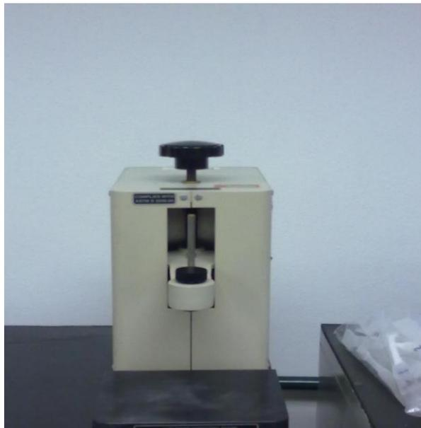
Figura 22. Máquina de Dureza Instron 900
